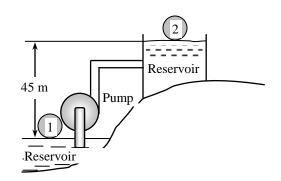
$$\Delta \dot{E}_{mech} = \dot{m} \Delta e_{mech} = \dot{m} \Delta p e = \dot{m} g \Delta z = \rho \dot{V} g \Delta z$$
