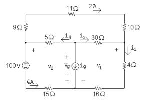
$v_2 = 100 + 4(15) = 160 \text{ V};$   $v_1 = 160 - (9 + 11 + 10)(2) = 100 \text{ V}$  $i_1 = \frac{v_1}{4 + 16} = \frac{100}{20} = 5 \text{ A};$   $i_3 = i_1 - 2 = 5 - 2 = 3 \text{ A}$  $v_g = v_1 + 30i_3 = 100 + 30(3) = 190 \text{ V}$  $i_4 = 2 + 4 = 6 \text{ A}$  $i_g = -i_4 - i_3 = -6 - 3 = -9 \text{ A}$
