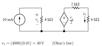
$$\frac{v_1}{2} = 2000i_0 + 6000i_0 = 8000i_0 \qquad \text{(KVL)}$$
