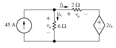
$-v_{\rm x} + v_{\rm o} + 2i_{\rm x} = 0 \qquad (\rm KVL)$
