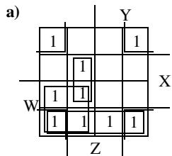
$$F = \bar{X}\bar{Z} + W\bar{Y} + W\bar{X} + X\bar{Y}Z$$
