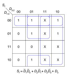
(c)  $D_2$  $D_3$  $D_1$  $D_0$ Sa Ś, s<sub>c</sub> ้ร<sub>d</sub> S<sub>e</sub> Ś,  $\dot{S}_{g}$
