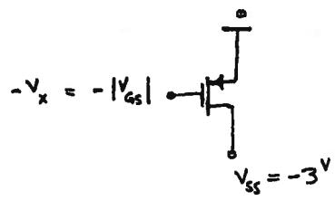
for  $|V_{GS}| < V_{th} (= 0.8)$   $I_D \approx 0$
